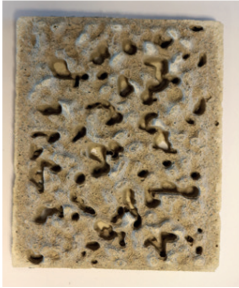
Figura 1. Biopolímero no homogéneo, compuesto por dos capas de distinta elasticidad. Desarrollado por Joaquín Rosas y Danisa Peric (FabLab U. de Chile). / Figure 1. Non-homogeneous biopolymer composed of two layers of different elasticity. Developed by Joaquín Rosas y Danisa Peric (Fab Lab Universidad de Chile). Figura 2. Estructura modular de bioplástico. Desarrollado por estudiantes del Programa Residencias Multidisciplinarias del FabLab U. de Chile. / Figure 2. Modular bio plastic structure. Developed by students at the Multidisciplinary Residence Program at Fab Lab Universidad de Chile.
