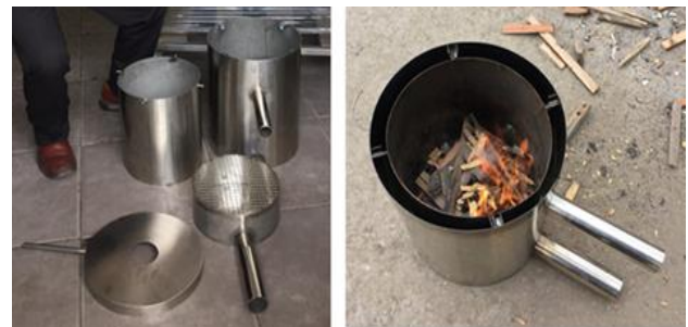
FIGURA 5. Vista (Izq.) Componentes de la estufa T-LUD preliminar construido; (Der.) vista interior de la estufa - cámara de combustión. Fuente: Elaboración propia.
