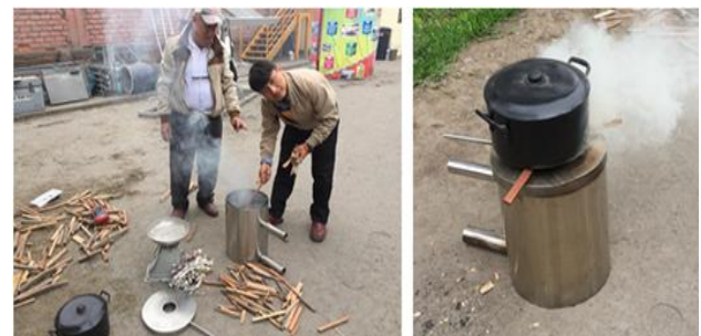
FIGURA 6. Vista de la Prueba de encendido desarrollada al prototipo preliminar construido. Fuente: Elaboración propia.
