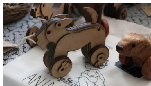
Figura 12. El corte láser permite crear piezas a medida, como este juguete (perrito), que está hecho de láminas de MDF seriadas (conjunto de planos bidimensionales que, colocados en el orden y distribución adecuada, representan o simulan un objeto tridimensional sólido). Este tipo de artesanías va cambiando la expresión de la cultura material.
